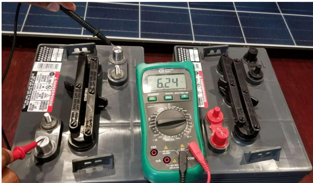
En esta imagen estoy utilizando un cable 1/0 con conectores en cobre, para conectar las baterías.
