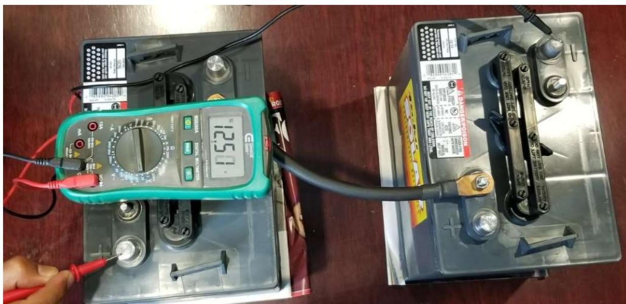
Si observas la imagen, puedes ver que estoy midiendo el polo positivo de una batería y el polo negativo de otra batería. Cuando hago este ejercicio, puedo medir un voltaje de 12.51v.
